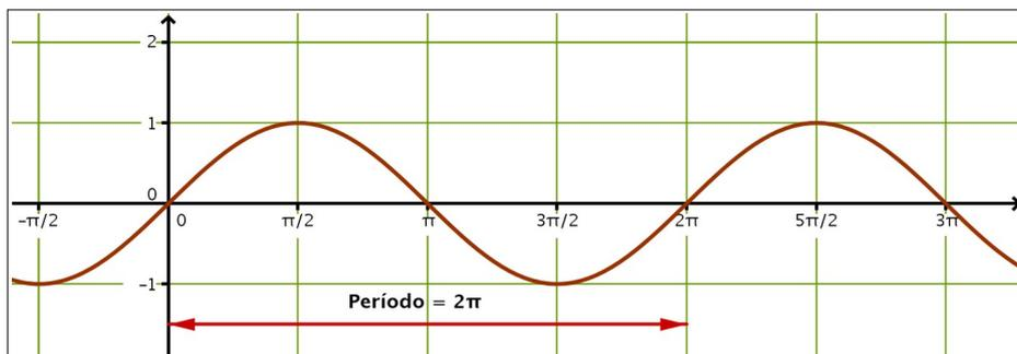
La línea obtenida se denomina curva sinusoidal. Es una función definida y continua en toda la recta real. Observa su forma de onda y un aspecto fundamental: su periodicidad. Es una función  $2\pi$ -periódica.
